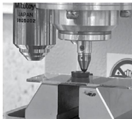
Fig. 1 Indentación en una muestra del cemento Cross Link (TP Orthodontics)
