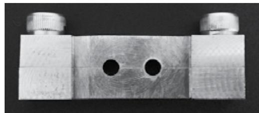
*Fig 1.- Molde para elaboración de muestras para fotocurado*
